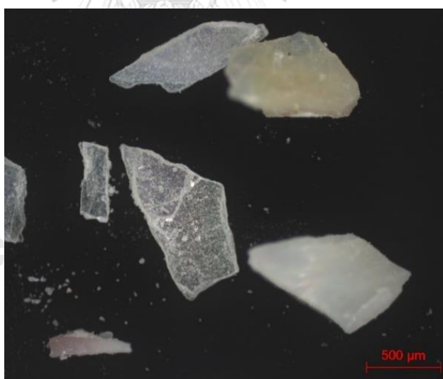
รูปที่ 3.14 รูปภาพแสดงเกล็ดเปลือกหอยแมลงภูขนาด 400-700 ไมโครเมตรถ่ายภาพด้วยกล้อง OPTICAL MICROSCOPE ขนาดกำลังขยาย 5x
