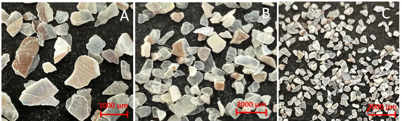
รูปที่ 3.19 ภาพแสดงลักษณะผลึกของอะราโกไนต์แคลเซียมคาร์บอเนตแปรรูปจากเปลือกหอยแมลงภูมีลักษณะเป็นแผ่นแบนขนาดใหญ่กว่า 1,000 ไมโครเมตร (A) ขนาด 1,000 ไมโครเมตร (B) และ ขนาด 400-700 ไมโครเมตร (C)
