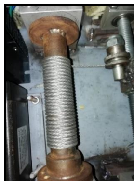
รูปที่ 3.5 แกนเพลลาพร้อมเชือกพันรอบขนาดเส้นผ่านศูนย์กลาง 2.5 เซนติเมตร
