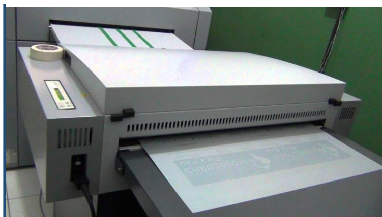
ภาพที่ 1.4 การทำแม่พิมพ์ (Plate Making) โดยเครื่อง Computer to plate
