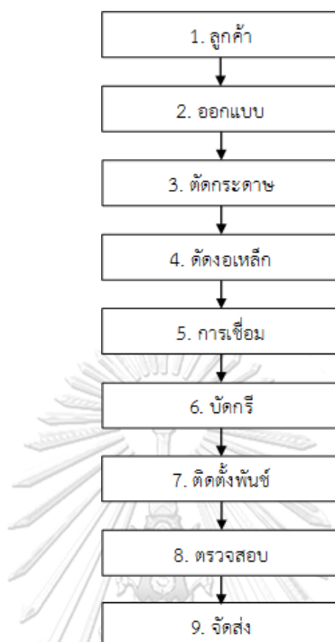
รูปที่ 1.3 ขั้นตอนกระบวนการผลิตแม่พิมพ์แบบตัด
