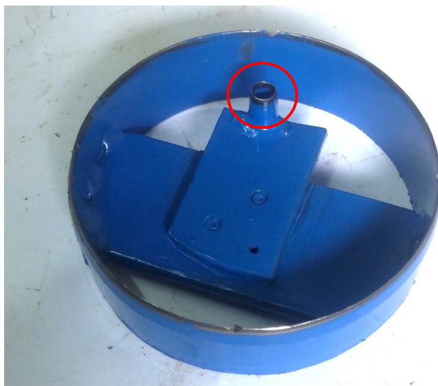
รูปที่ 4.4 การติดตั้งพินซ์บนแม่พิมพ์
