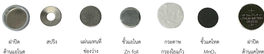
รูปที่ 3.2 ส่วนประกอบของแบตเตอรี่แบบเต็มเซลล์
