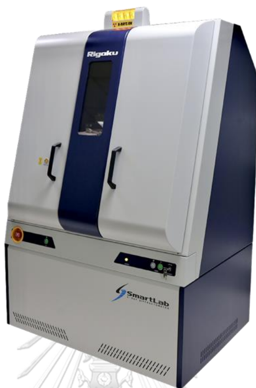
รูปที่ 3.7 เครื่องวิเคราะห์การเลี้ยวเบนของรังสีเอ็กซ์ รุ่น SmartLab จาก Rigaku
