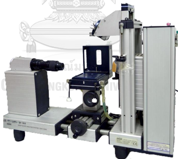
รูปที่ 3.8 เครื่องวัดมุมสัมผัส รุ่น DSA10-MK2 จาก Kruss
