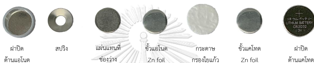
รูปที่ 3.1 ส่วนประกอบของแบตเตอรี่แบบเซลล์สมมาตร
