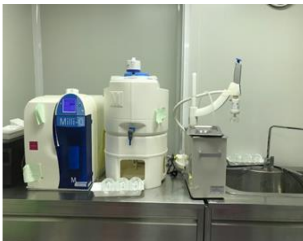
รูปภาพที่ 4 ชุดเครื่องล้างเครื่องมือและอุปกรณ์โดยใช้คลื่นความถี่สูง (Ultrasonic cleaner) (หมายเลข 1 ในผัง)
