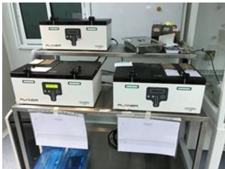
รูปภาพที่ 9 ตู้อบ Planer BT37 ซึ่งบรรจุจานที่มีไข่ (รอผสม) และตัวอ่อนที่ผสมแล้ว ถูกควบคุมอุณหภูมิไว้ที่ 37 องศาเซลเซียส (หมายเลข 5 ในฝั่ง)
