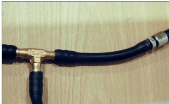
รูปที่ 4. แสดงการเชื่อมต่อระหว่างเครื่องวัดความดันและรางเชื่อมแรงดันส่วนกลาง
