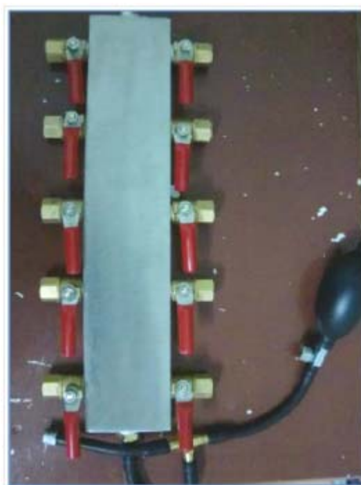
รูปที่ 2. ตัวเก็บแรงดันสำหรับดวงตาจำลองที่เชื่อมต่อกับรางเชื่อมแรงดันในระบบ
