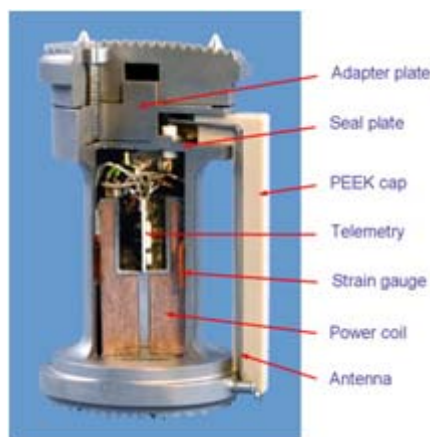
รูปที่ 4. Cut model of the telemeterized vertebral body replacement (9)
