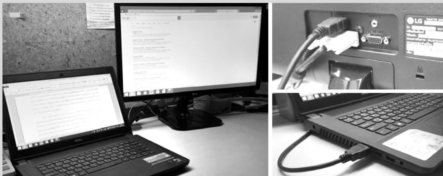
รูปที่ 5 เครื่องคอมพิวเตอร์โน้ตบุ๊ก ที่ติดตั้งหัวเสียบ RGB หรือ HDMI สามารถเสียบร่วมกับ จอมอนิเตอร์เพิ่มได้อีก
