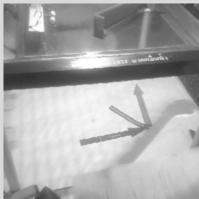
ภาพ 1 การทดลองสมบัติการเลี้ยวเบน
