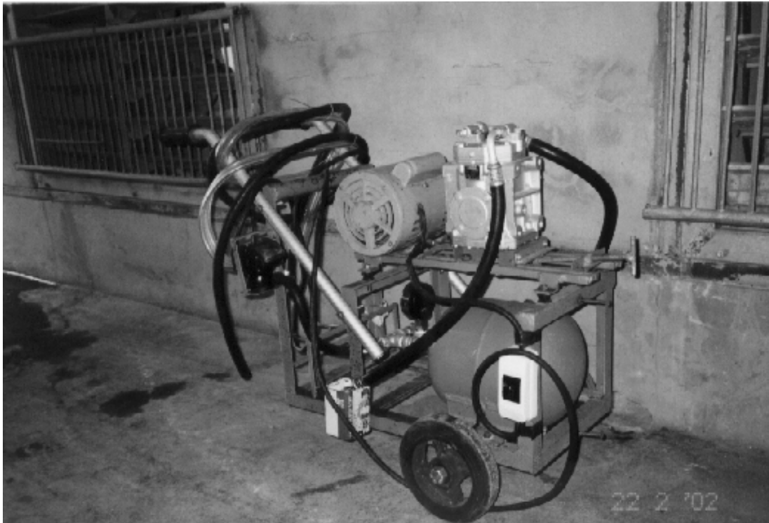
รูปที่ 1 แสดงเครื่องรีดนมแม่สุกรด้วยไฟฟ้า
