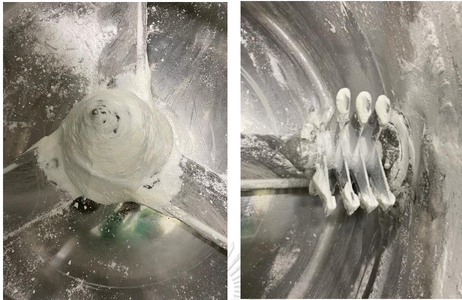
รูปที่ 17 ใบพัด Agitator (ซ้าย) และใบพัด Chopper (ขวา) ที่มีผงยาติดบริเวณใบพัด
