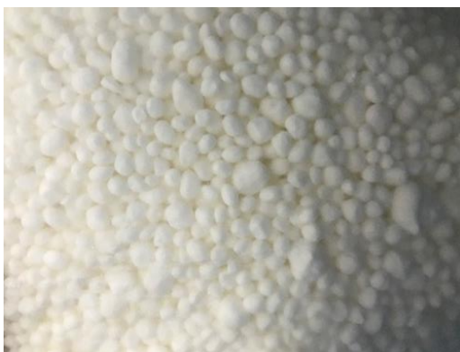
รูปที่ 11 Rejected granule หลังกระบวนการทำแกรนูลเปียกของยาเมตฟอร์มิน
