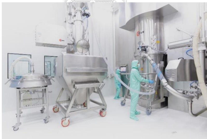
รูปที่ 10 ถังบรรจุแกรนูลแห้งสำหรับนำไปหมุนผสมและตอกเม็ดยา
