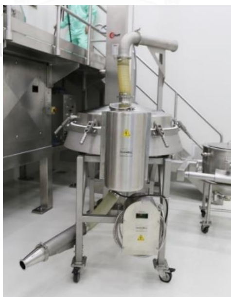
รูปที่ 6 เครื่องแรงที่ใช้สำหรับการคัดขนาด ภายในมีแรงที่มีขนาดตามที่กำหนดของแต่ละผลิตภัณฑ์
