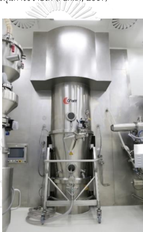
รูปที่ 7 เครื่องอบแห้งแกรนูลที่ได้รับแกรนูลเปียกมาจากเครื่อง High shear granulator
