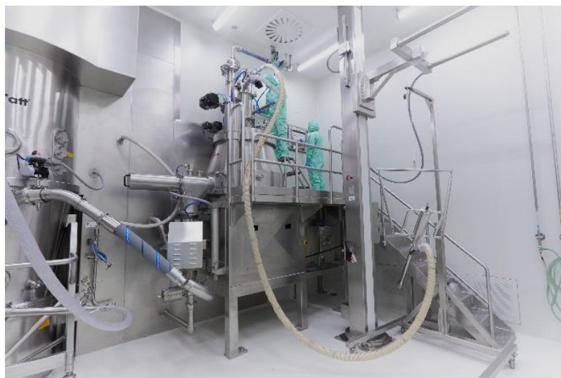
รูปที่ 9 ท่อที่ใช้ในการนำส่งแกรนูล เชื่อมต่อกับระบบ Vacuum transfer system
