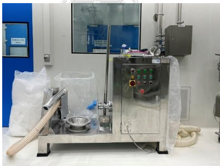
รูปที่ 3 เครื่องบีบอัดใช้สำหรับบีบอัดวัตถุดิบยาเมตฟอร์มิน
