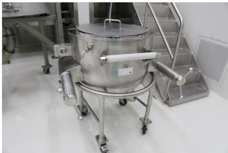
รูปที่ 2 ภาพสำหรับบรรจุสารยึดเกาะ เป็นส่วนหนึ่งของเครื่อง Paste preparation vessel
