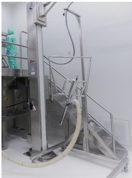
รูปที่ 4 เครื่อง Lump breaker suction lance ใช้ในการลดขนาดก้อนยาเมตฟอร์มีน และนำส่งไปยังเครื่อง High shear granulator
