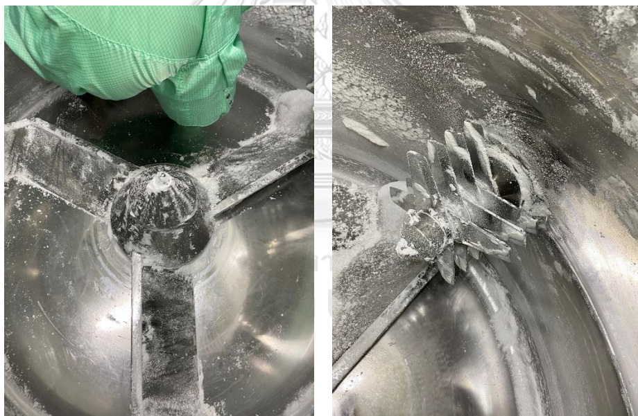
รูปที่ 18 ใบพัด Agitator (ซ้าย) และใบพัด Chopper (ขวา) ที่ได้รับการทำความสะอาดเบื้องต้น
