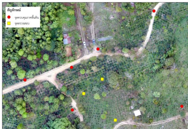
ภาพที่ 21 การกำหนดจุดควบคุมภาคพื้นดินและจุดตรวจสอบ
