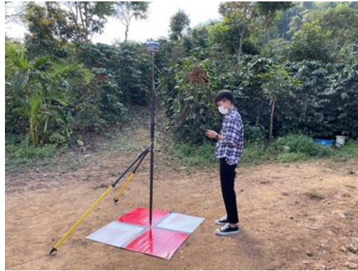
ภาพที่ 22 การสำรวจรังวัดค่าพิกัดของจุดควบคุมภาคพื้นดินและจุดตรวจสอบ
