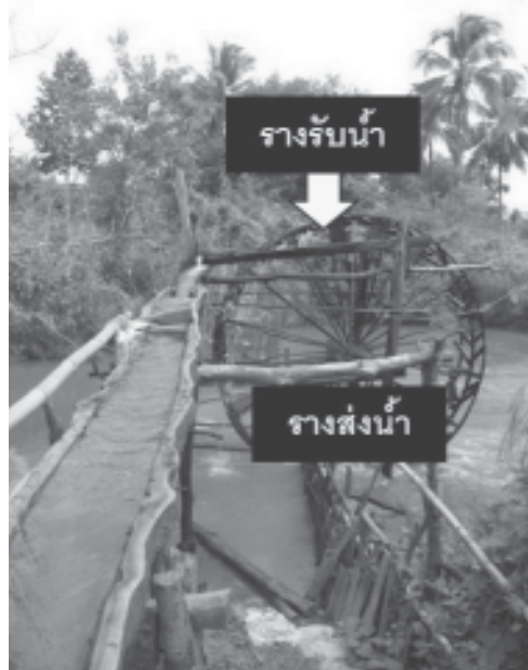
ภาพที่ 3 รางรับและรางส่งน้ำของระหัดวิดน้ำ ที่มา : ปรับปรุงจาก http://www.oknation.net/blog/navycom/2008/07/29/entry-2
