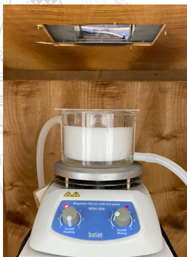
ภาพที่ 3.1 เครื่องปฏิกรณ์เชิงแสงที่ใช้เตรียมตัวเร่งปฏิกิริยาในตู้ป้องกันแสงยูวี
