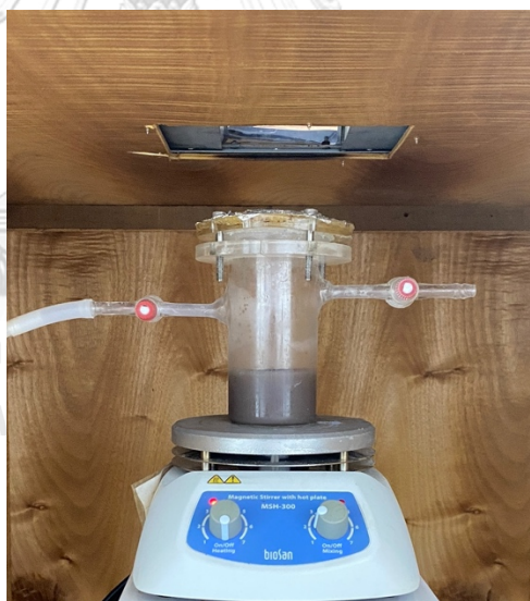
ภาพที่ 3.2 เครื่องปฏิกรณ์ผลิตไฮโดรเจนในตู้ป้องกันแสงยูวี
