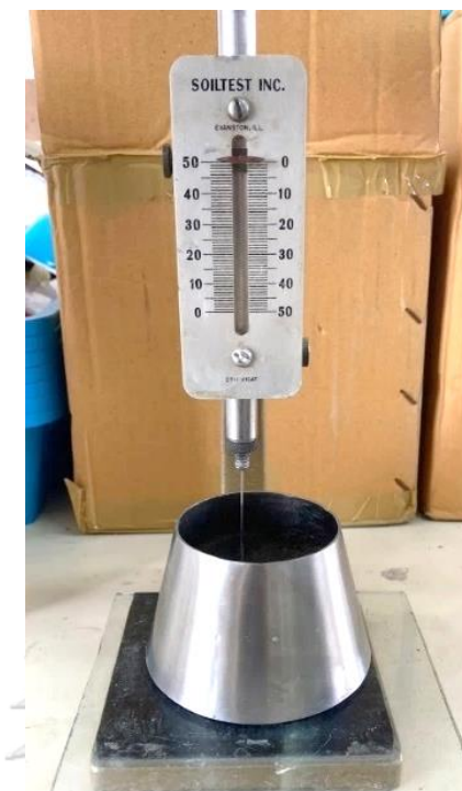
รูปที่ 3.11 เครื่องมือหาเวลาการก่อตัวของซีเมนต์เพสต์ (Vicat apparatus)
