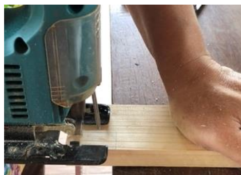
ภาพที่ 233 เลื่อยตำแหน่งบากไม้ ที่มา : ผู้วิจัย
