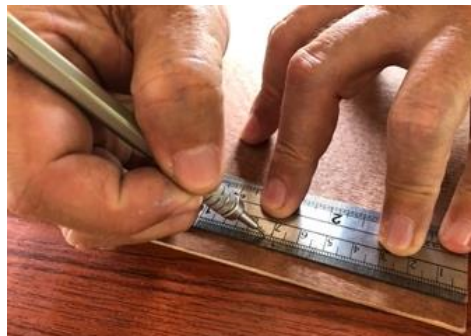
ภาพที่ 242 วัดหาตำแหน่งยึดตะปูเกลียว ที่มา : ผู้วิจัย
