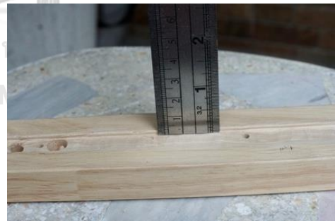
ภาพที่ 163 วัดความลึกของร่องไม้ ที่มา : ผู้วิจัย
