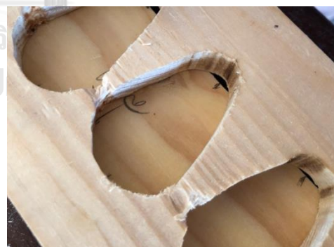
ภาพที่ 290 ประกอบไม้สำหรับฝังฐานกระบอกสูบ ที่มา : ผู้วิจัย
