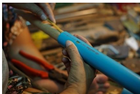
ภาพที่ 76 ตรวจสอบตำแหน่งไม้ดากด้วยไม้กระสวน ที่มา : ผู้วิจัย
