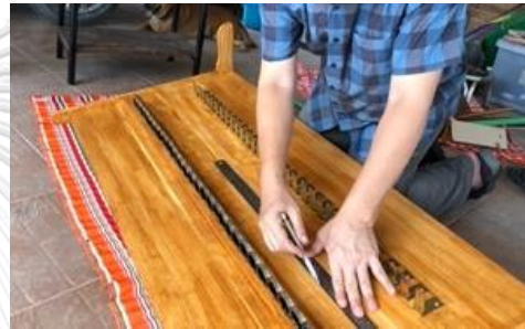
ภาพที่ 196 ซีดเส้นทำแนวเจาะสายลม ที่มา : ผู้วิจัย
