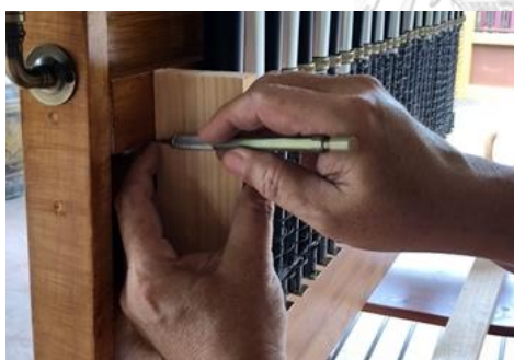
ภาพที่ 228 กำหนดตำแหน่งบากไม้ ที่มา : ผู้วิจัย
