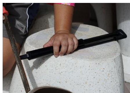
ภาพที่ 131 ขัดก้านจับด้วยตะไบแบน ที่มา : ผู้วิจัย
