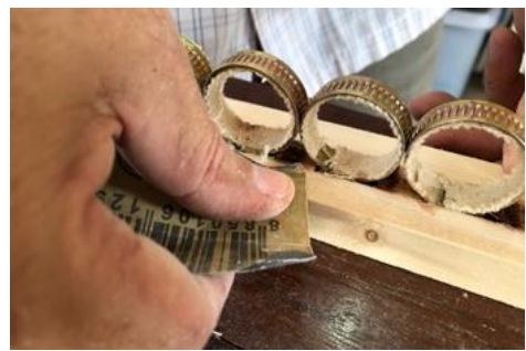
ภาพที่ 182 ขัดกาวร้อนและฝังไม้ด้วยกระดาษทราย ที่มา : ผู้วิจัย
