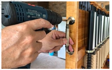
ภาพที่ 199 ติดตั้งหูจับ ที่มา : ผู้วิจัย
