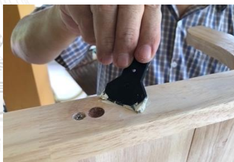
ภาพที่ 167 อุดร่องไม้
