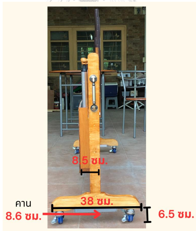
ภาพที่ 54 สัดส่วนและส่วนประกอบระบบลมภายในของลมรายที่พัฒนา ครั้งที่ 2 ที่มา : ผู้วิจัย
