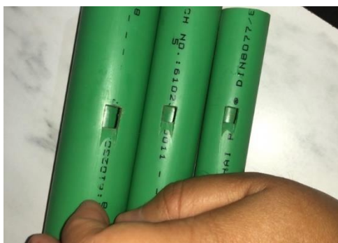
ภาพที่ 32 ท่อ PPR ที่เจาะปากนกแก้วแล้ว
