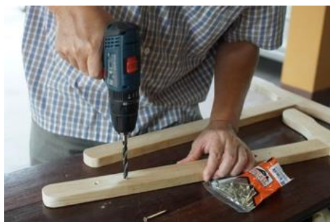
ภาพที่ 156 เจาะไม้เสาตัวเรือน ที่มา : ผู้วิจัย
