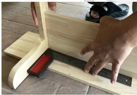
ภาพที่ 164 ประกอบไม้แผงกับเสา ที่มา : ผู้วิจัย
