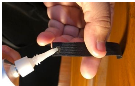
ภาพที่ 192 ติดผ้าสักหลาดด้วยกาวอเนกประสงค์
