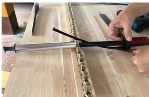
ภาพที่ 187 หาดำแหน่งการติดตั้งเหล็กฉาก ที่มา : ผู้วิจัย
