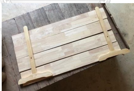
ภาพที่ 154 ขาตัวเรือนและไม้แผงตัวเรือน ที่มา : ผู้วิจัย
