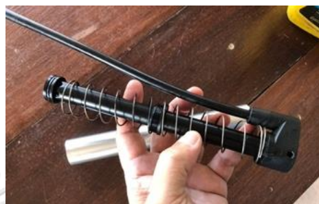
ภาพที่ 200 สวมสปริงเข้ากับก้านลูกสูบ ที่มา : ผู้วิจัย
