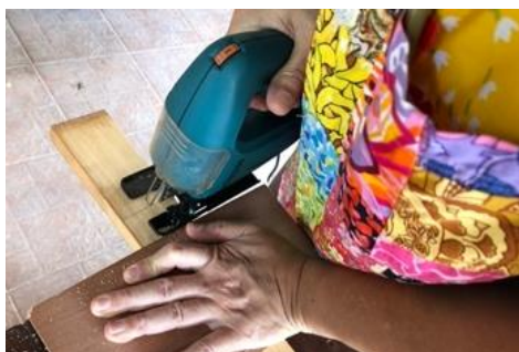
ภาพที่ 226 เลื่อยไม้ทำกล่องปิดระบบลูกสูบ ที่มา : ผู้วิจัย
