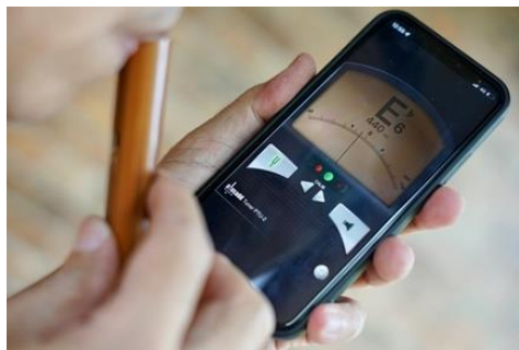
ภาพที่ 87 ทดสอบเสียงท่อลมขนาดกลาง ที่มา : ผู้วิจัย
