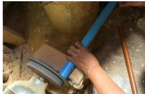
ภาพที่ 79 ขัดแต่งพื้นผิวไม้ตากบริเวณหน้าตัด ที่มา : ผู้วิจัย
