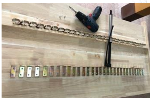
ภาพที่ 189 ตัวเรือนที่ติดตั้งเหล็กฉากแล้ว ที่มา : ผู้วิจัย
