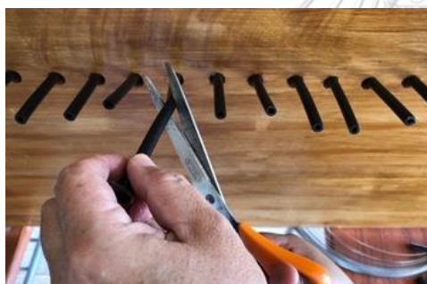
ภาพที่ 213 ตัดสายลม
