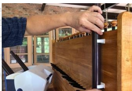
ภาพที่ 219 ติดท่อเสียงเข้ากับก้ามปู ที่มา : ผู้วิจัย
