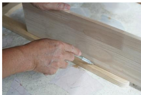
ภาพที่ 157 ใช้ดินสอลากเส้นเพื่อทำแนว 1 ที่มา : ผู้วิจัย
