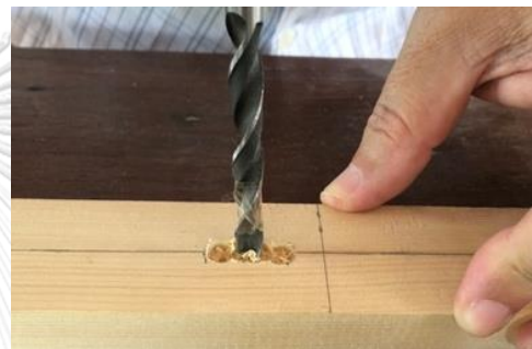
ภาพที่ 177 เจาะนำรูด้วยสว่าน ที่มา : ผู้วิจัย
