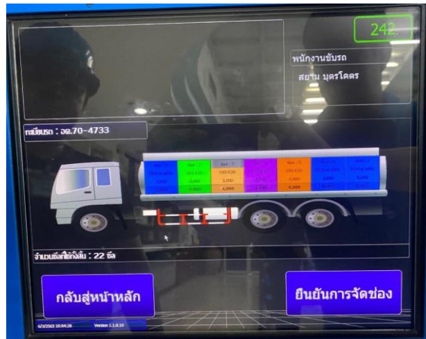
รูปที่ 1.28 การกำหนดปริมาณที่ต้องการเติมที่ตู้ I-Terminal
