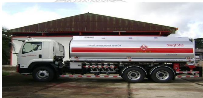
รูปที่ 1.12 รถบรรทุกน้ำมันขนาด 16,000 ลิตร
