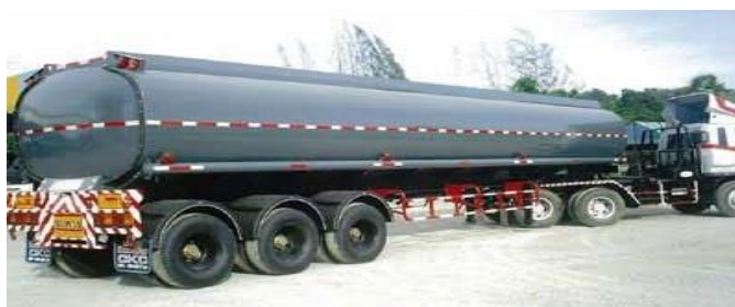
รูปที่ 1.13 รถบรรทุกน้ำมันขนาดมากกว่า 16,000 ลิตร
