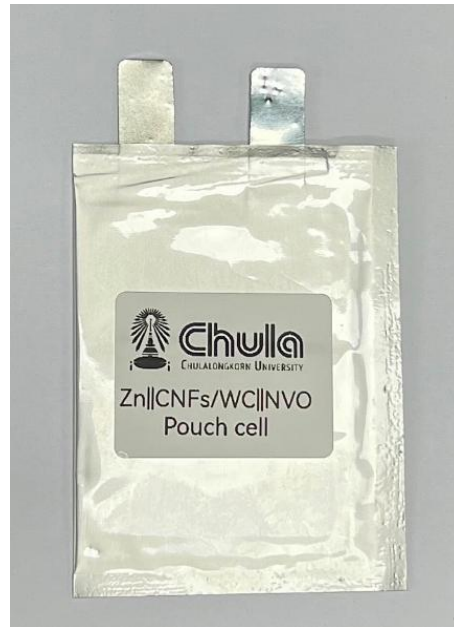
รูปที่ 67 แบตเตอรี่ Zn||NVO แบบกระเป๋ที่ใช้ตัวคั่น CNFs/WC
