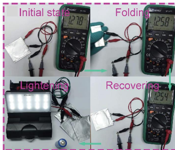
รูปที่ 70 แบตเตอรี่ Zn||NVO แบบกระเป๋าที่ใช้ตัวคั่น CNFs/WC พร้อมแรงดันไฟฟ้าภายใต้สถานะต่างๆ
