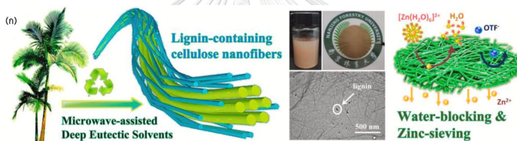
รูปที่ 8 แผนผังของกระบวนการผลิตเส้นใยนาโนลิกโนเซลลูโลส [19]
