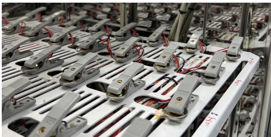
รูปที่ 48 รูปภาพการทดสอบแบตเตอรี่ด้วยเครื่องทดสอบแบตเตอรี่ BTS (BTS battery tester)
