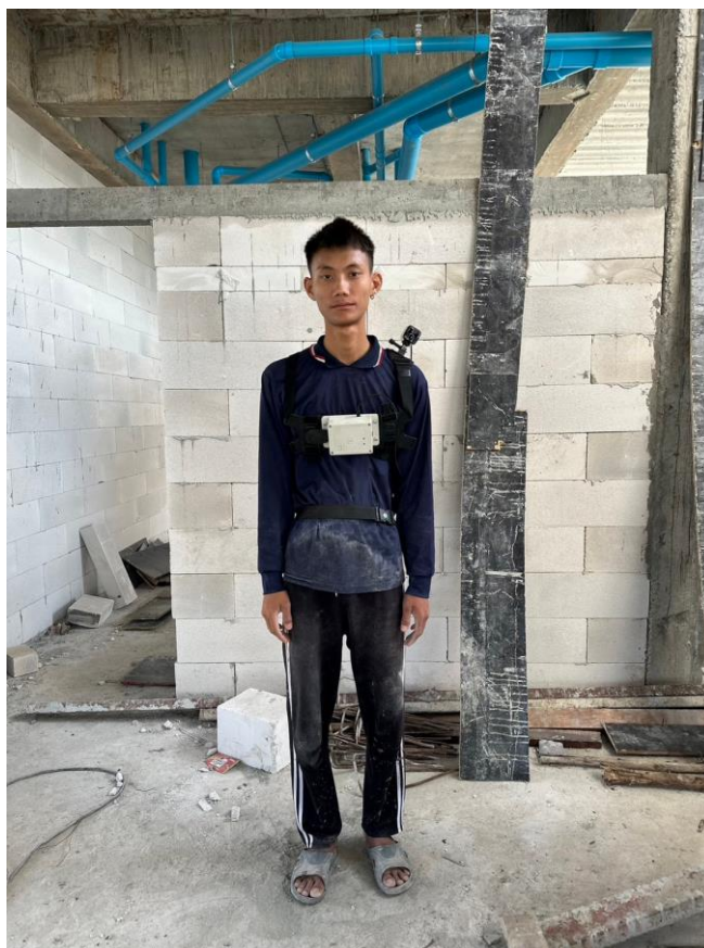
รูปที่ 5.22 รูปภาพแสดงแรงงานที่ติดตั้งเครื่องมือวัดปริมาณมลพิษทางอากาศและ เสียงส่วนบุคคล (กิจกรรมก่ออิฐฉาบปูน คนที่ 2)
