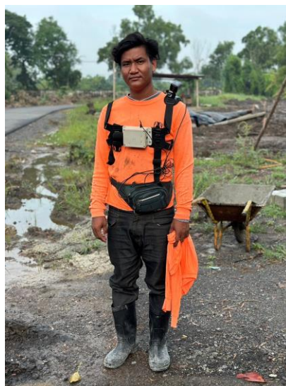
รูปที่ 5.6 รูปภาพแสดงแรงงานที่ติดตั้งเครื่องมือวัดปริมาณมลพิษทางอากาศและเสียงส่วนบุคคล (กิจกรรมเชื่อมโลหะ คนที่ 1)
