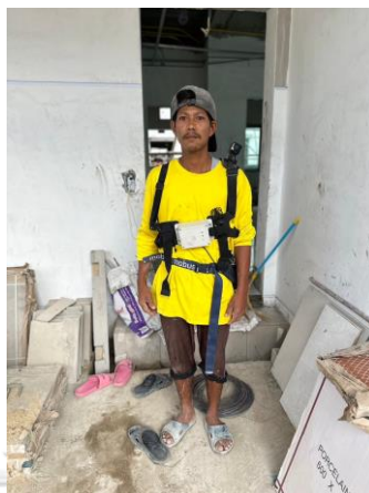
รูปที่ 5.26 รูปภาพแสดงแรงงานที่ติดตั้งเครื่องมือวัดปริมาณมลพิษทางอากาศและ เสียงส่วนบุคคล (กิจกรรมปูกระเบื้องห้องครัว คนที่ 1)
