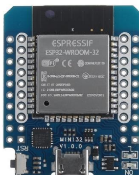
รูปที่ 4.4 รูปภาพแสดงโมดูล ESP32 MH-ET LIVE D1 mini ESP32 ESP-32 WiFi+Bluetooth Internet of Things development board CH9102 ที่ใช้ในงานวิจัย
