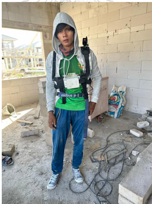
รูปที่ 5.19 รูปภาพแสดงแรงงานที่ติดตั้งเครื่องมือวัดปริมาณมลพิษทางอากาศและเสียงส่วนบุคคล (กิจกรรมก่ออิฐฉาบปูน คนที่ 1)
