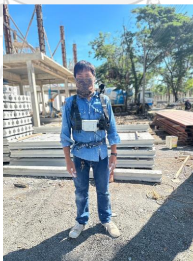
รูปที่ 5.32 รูปภาพแสดงแรงงานที่ติดตั้งเครื่องมือวัดปริมาณมลพิษทางอากาศและเสียงส่วนบุคคล (กิจกรรมทาสี คนที่ 1)
