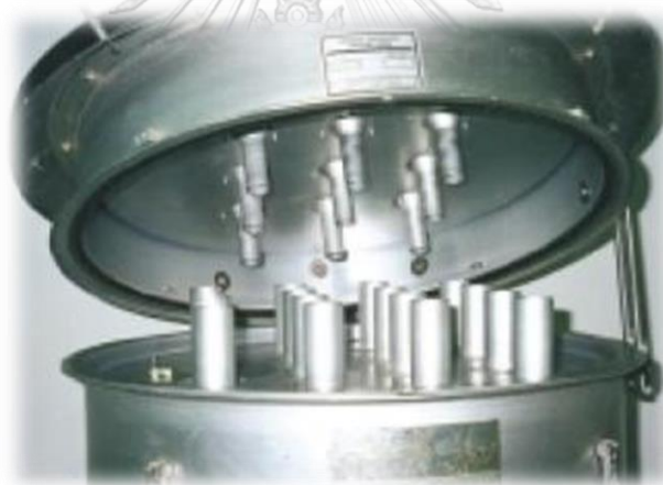
รูปที่ 2.3 หัวคัดขนาดฝุ่นละอองขนาดไม่เกิน 10 ไมครอน (กรมควบคุมมลพิษ, 2546)
