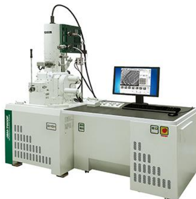
รูปที่ 3.11 Field Emission Scanning Electron Microscopy (FESEM) ยี่ห้อ JEOL รุ่น JSM 7800F ประเทศญี่ปุ่น
