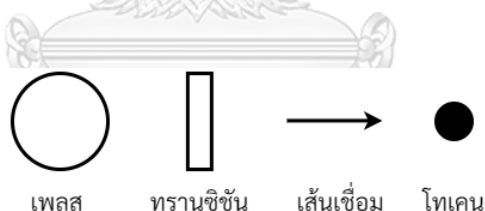
รูปที่ 2.2 สัญลักษณ์ขององค์ประกอบของแบบจำลองเพทรีเน็ต [21]
