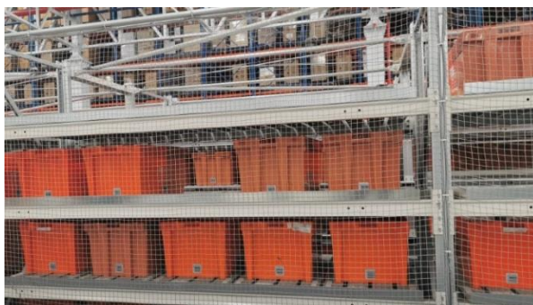
รูปที่ 3-8 ตัวอย่าง Shuttle Rack AS/RS ที่ใช้เก็บสินค้าคงคลัง
