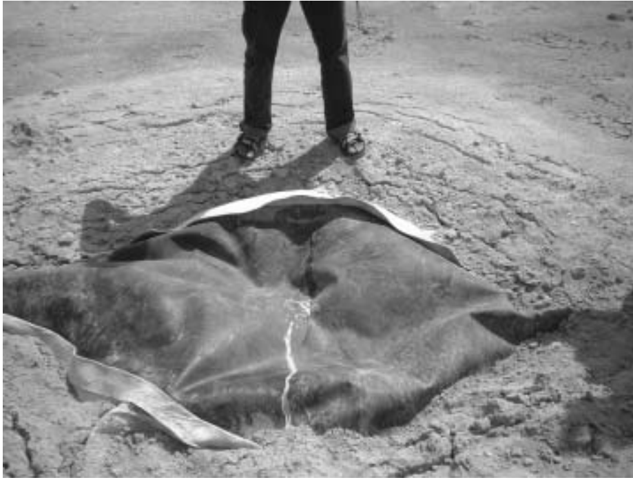
การบุดพองเสียหายสภาพของแผ่น HDPE จากความร้อนที่เกิดจากการตากแดดเป็นเวลานาน (ภาพโดย ดร.ทรงกฤษณ์ ประภักดิ์)
