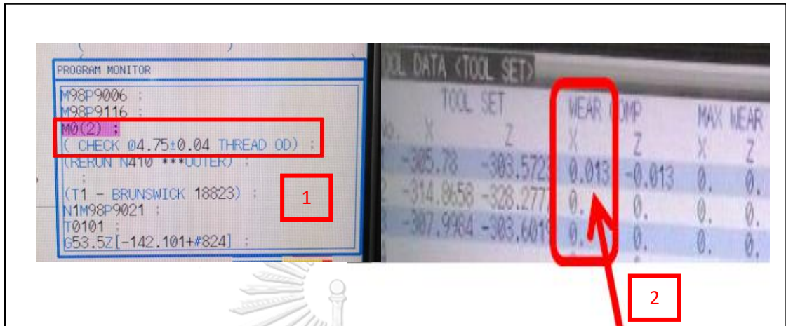
รูปที่ 3.3 หน้าจอโปรแกรมบนเครื่องกลึงซีเอ็นซีสำหรับการปรับความลึกการตัด
