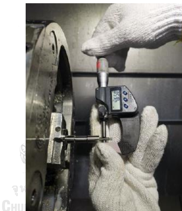
รูปที่ 3.2 การวัดขนาดเส้นผ่าศูนย์กลางชิ้นงานด้วยไมโครมิเตอร์ก่อนปรับความลึกการตัด
